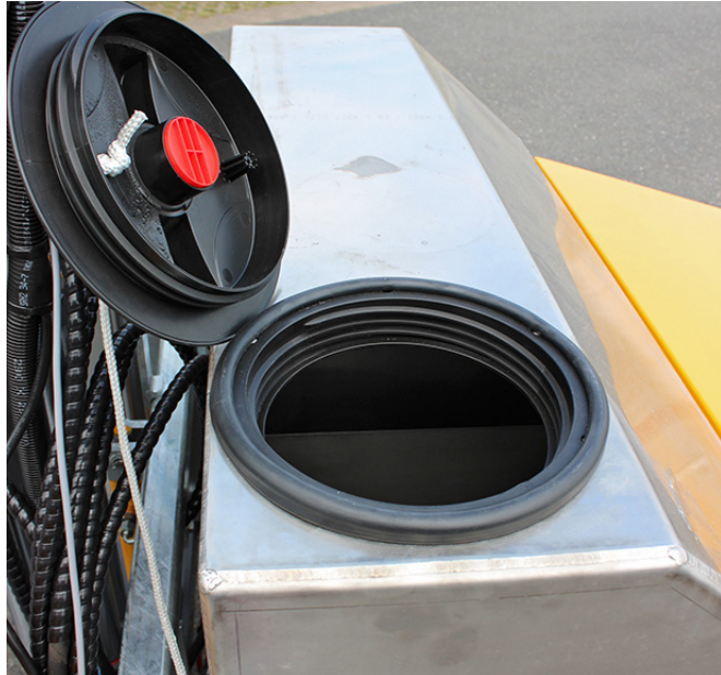
Wassereinfüllöffnung am Wassertank
